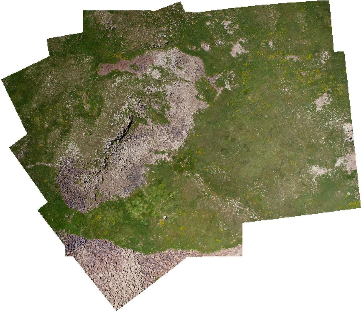
Abb.4.: Bildmontage der Einzelaufnahmen einer Lavablockhalde mit anschließender Entzerrung und Georeferenzierung
